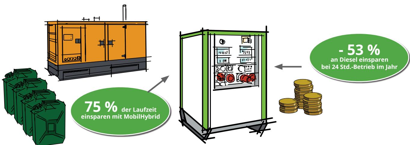
Meist ist die benötigte Energiemenge gar nicht besonders hoch oder unterliegt stark schwankenden Stromverbrächen. Dieselgeneratoren haben bei geringer Last, also wenigen oder schwachen Verbrauchern, einen extrem schlechten Wirkungsgrad, was den Treibstoffverbrauch unverhältnismäßig in die Höhe treibt.
