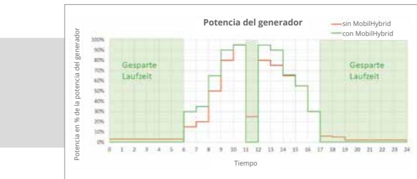
El **MobilHybrid** permite un suministro óptimo de corriente y lo controla todo de forma completamente automática.
